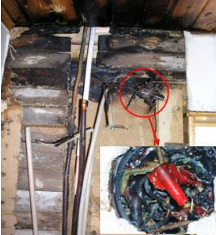
Bild 1 visar eldosan ute på altanen där pilen markerar området för den inträffade överlagsskadan och bild 2 visar eldosan i köket samt den brandskadade väggen och det brandskadade taket.
