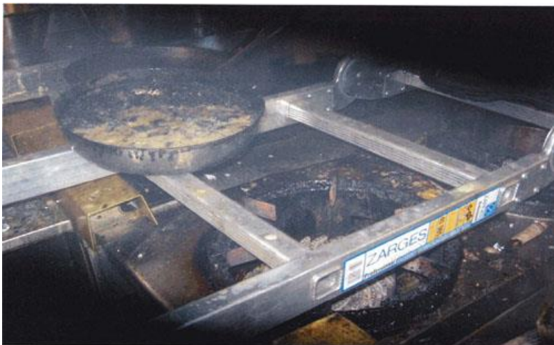
Branden startade i oljan i denna frityrpanna en restauranganställd försökte släcka och fick lindrigare brännskador.
