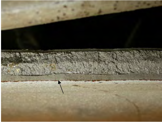
Figur 5. Utmattningsyta på prov 5.1.
