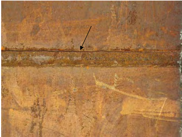
Figur 6. Spricka på insidan av prov 6.4.
