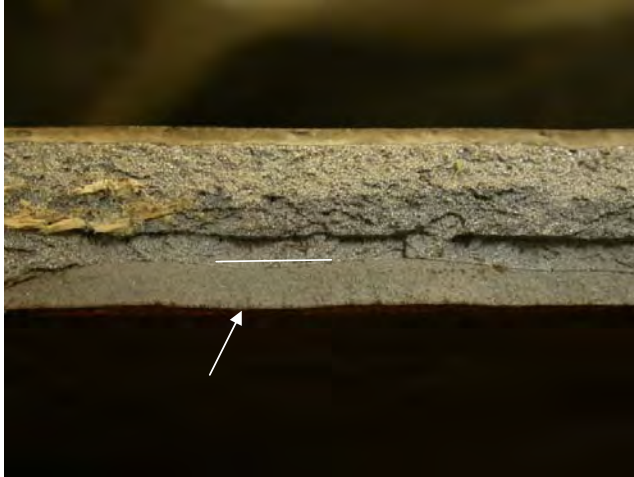
Figur 3. Utmattningsyta på prov 5.2. Insidan nedåt (pil). Gräns mellan utmattning och restbrott markerat med linje. Utmattningsytan i bilden är inte den djupaste på prov 5.2.
