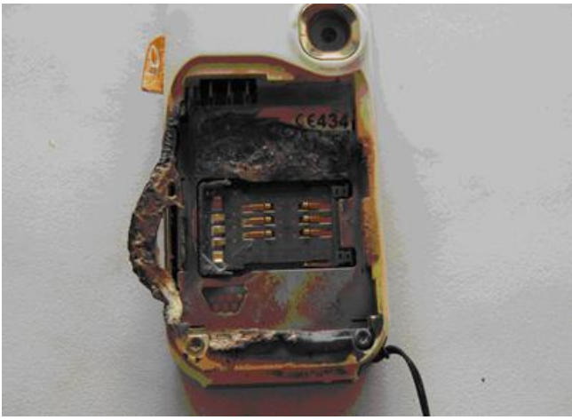
Märke X (identifierat märke). Skador runt batteriets infästning.
