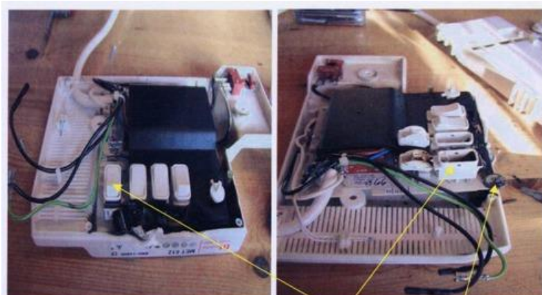
Termostatdelens skadade insida med elementets strömbrytare och keramikkomponenten.
