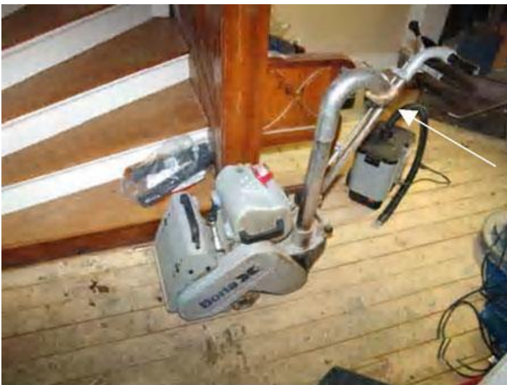
Den aktuella golvslipmaskinen, resterna av den avbrända uppsamlingspåsen satt fortfarande kvar på handtaget
