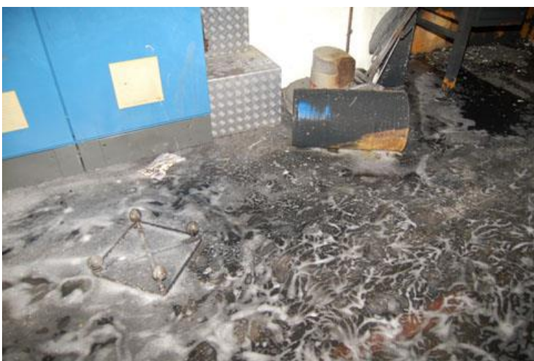
Stålfat som innehöll den antända vätskan, hjulställ som kärlet stod på vid fyllningen.
