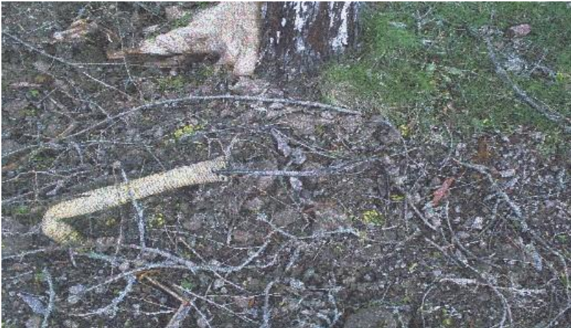
Gropen som bildats vid trädets rot samt elledningarna som fläkts upp ur marken.
