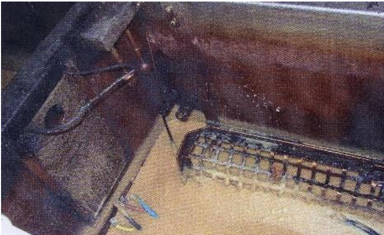
Doppkaret sett från ovan. Vaxnivån har enligt brandskadorna varit betydligt högre under branden.
