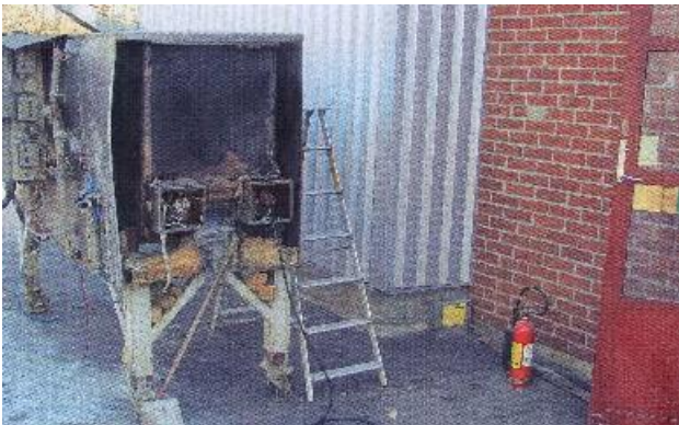
Vaxgrytan sedd från gavelsidan med förvärmningskaret närmast. Den är uppställd utomhus för test av ett värmerör och temperaturmätning. Ytterplåten på gaveln är borttagen.
