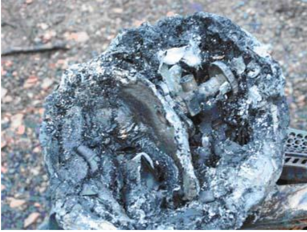
Rester av vad som finns kvar av gasolflaskan tillverkad i aluminium.
