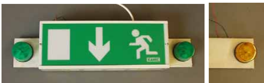
Figur 4.1 Genomlyst utrymningsskylt med kompletterande blyxtljus.
