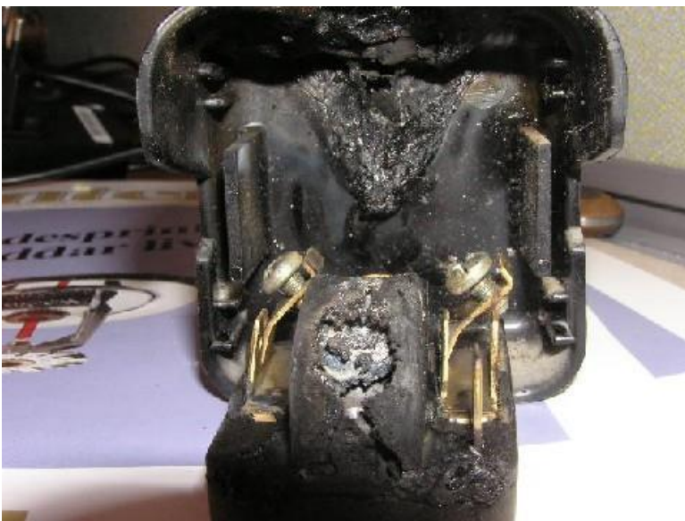
Innanför smältningen sitter kontakterna i reläet.
