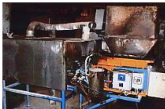
Sida av maskinen. Gasolbrännare dold under plåtar.
