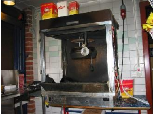
Popcornmaskinen. Glasrutorna på maskinens båda sidor sprängdes av värmen. Normalt skall det vara glasluckor på maskins front, men dessa var borttagna vid branden
