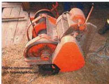
Hölift i originalutförande med kilremsskydd.
