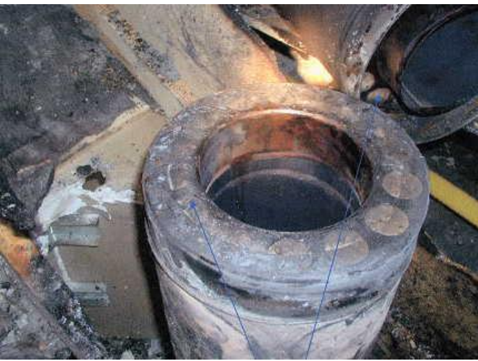
Skarven isärtagen. Här syns brandskadorna inuti skarven.
