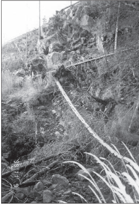
Figur 2.3 Skred i sidoslänt till bäckravin – Syslebäck, Värmland. Foto: Jan Fallsvik, SGI.
