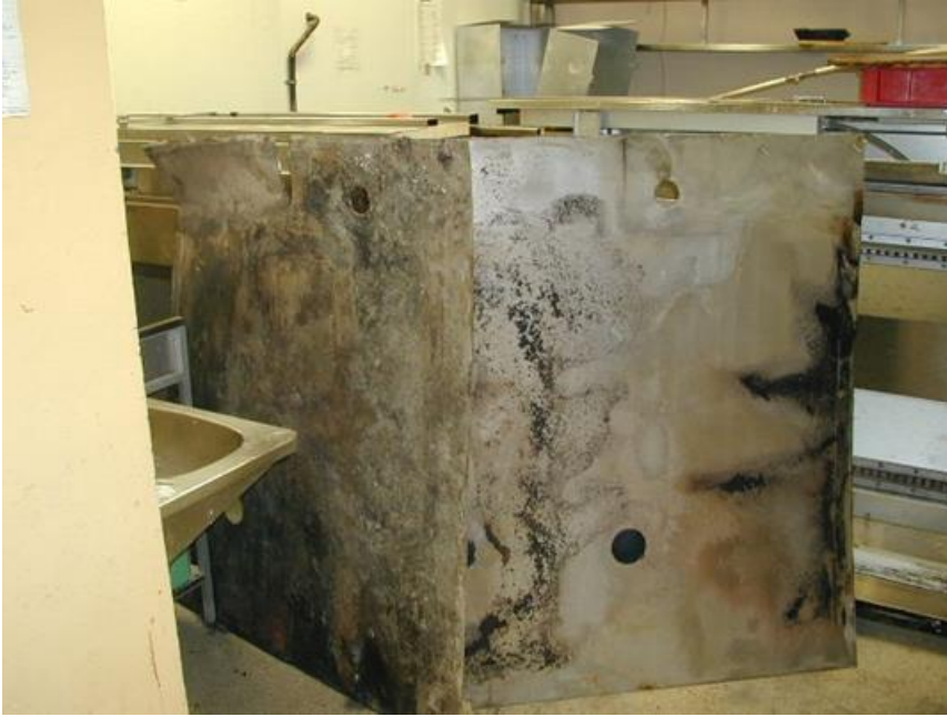
En av bottenplåtarna för ugnarna. Här syns hålen som fanns i plåtarna. Det nedre är det som var orsak till värmespridningen.
