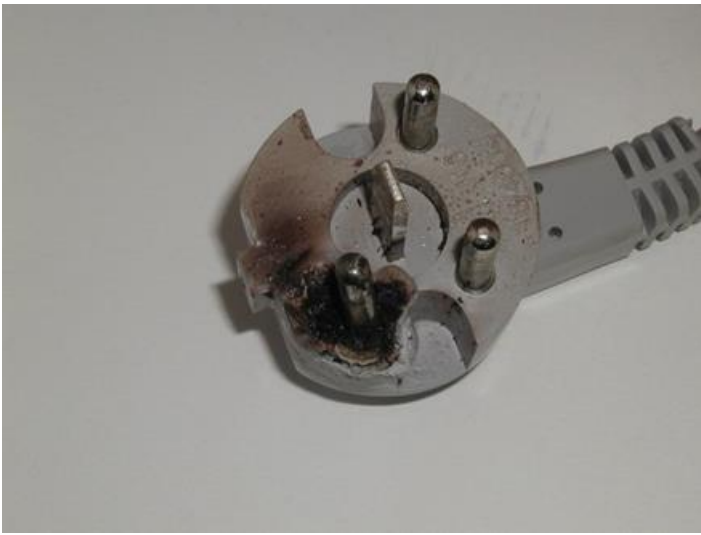
Uttagets locks utsida som uppvisar betydligt större sot- och värmeskador än insidan
