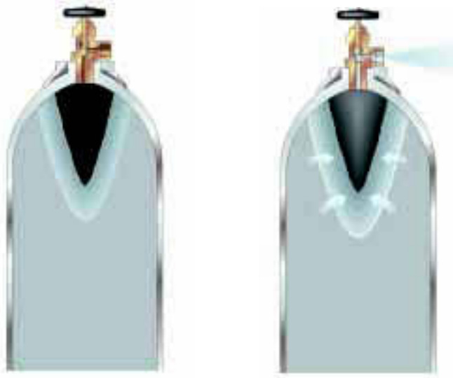
Tät och otät flaska. I den otäta läcker det ut gas ur ventilen, och det inerta täcket slås sönder.
