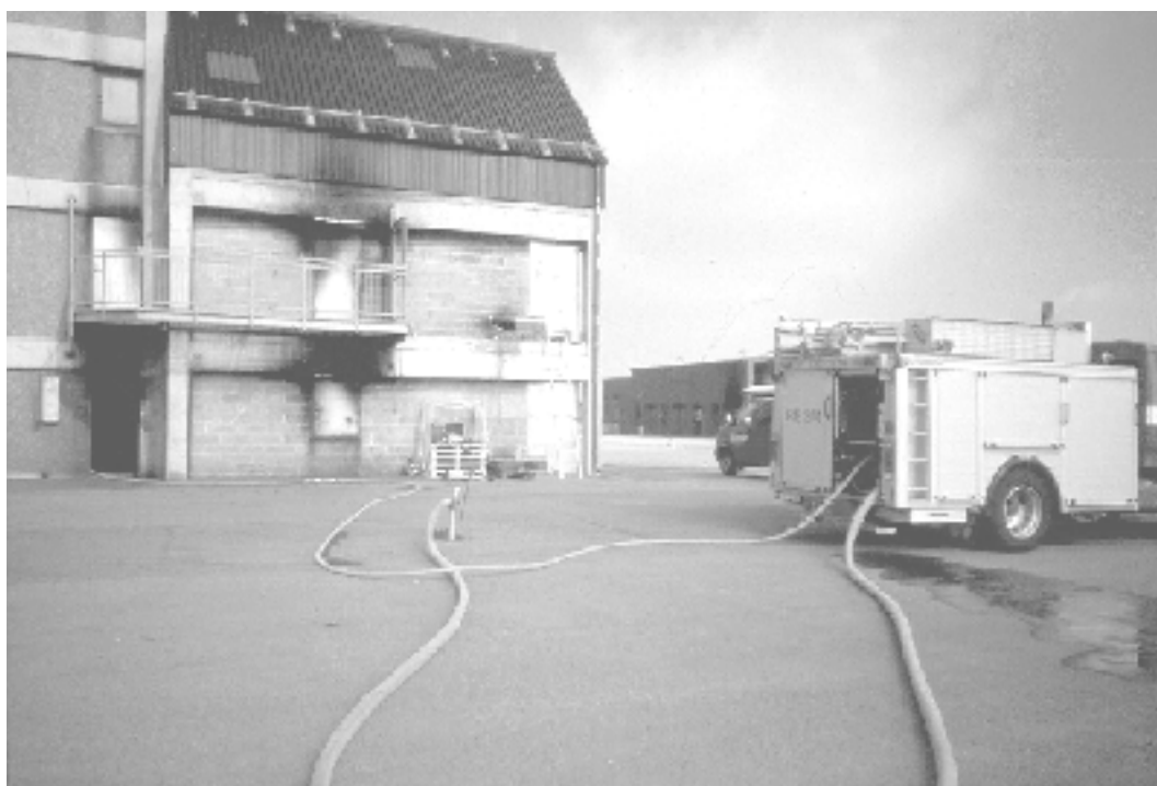
Figur 1. Brandövningshuset vid Räddningsverkets skola i Revinge, uppställning av släckfordon till höger, slangdragning samt uppställning av logger mm vid mätplatsen (pallstapel) mitt i bilden.
