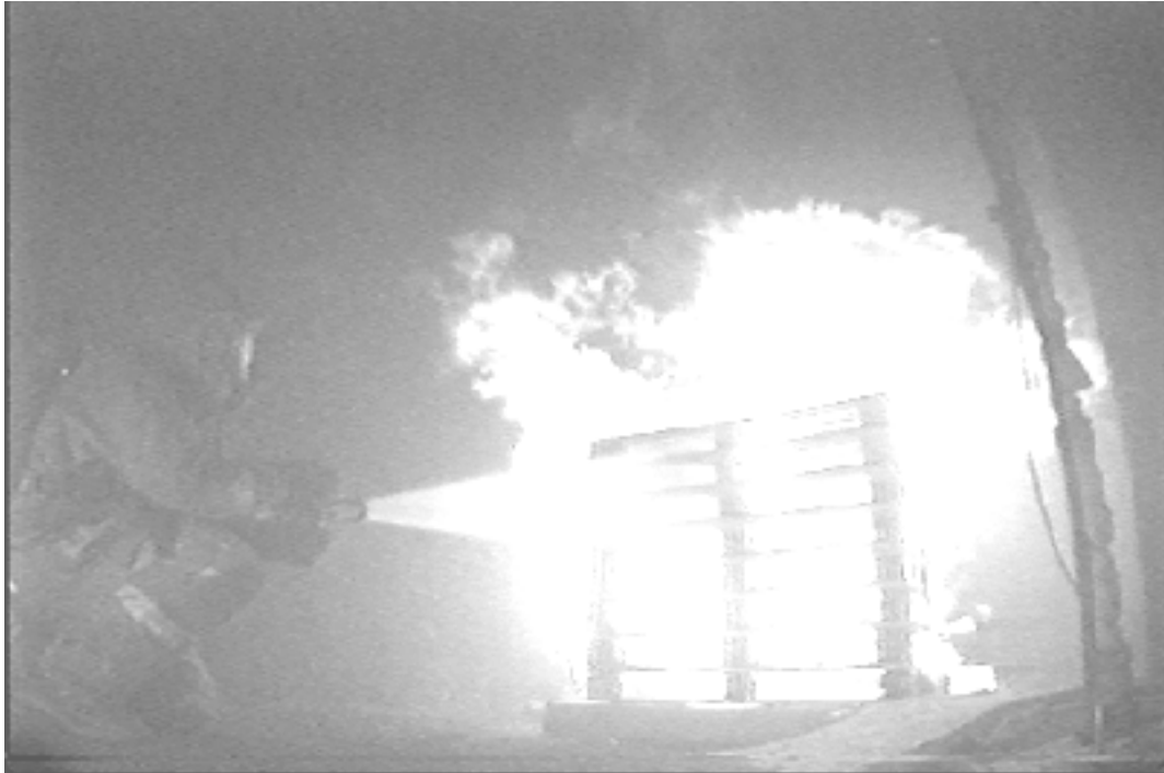
Figur 10. Försök 11, t = 494 s (strax efter strålröret är öppnat, då de första dropparna träffar brandhärden). Bilden är tagen från videofilm (Hubert).
