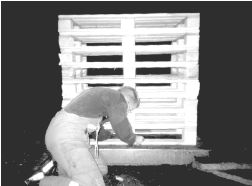
Figur 4. Antändning av bränslet, observera även bränslets (lastpallar) placering på vågplattform.
