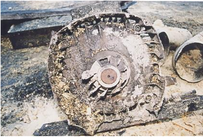
Motorns flätkåpa demonterad, ansamlingar av spån på insidan. Kylfläkten är delvis smält och delvis sönderbruten, troligtvis vid fall från hög höjd.
