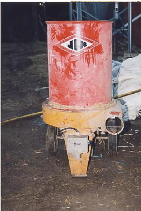
Halmhackningsmaskinen. Den röda delen utgör tratt för inmatning av råvara.
