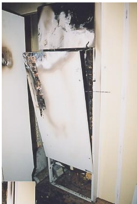
Värmeväxlarens utsida. Primärområde runt manöverpanelen. Till vänster syns en bordsskiva till vilken branden spridit sig.
