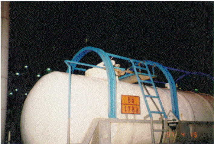
Tankbil från skogshallsverken innehåller 8 m 2 . Överpumpning sker över topp till manlucka.
