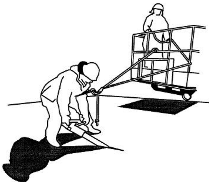
Förankring i höjdfordon med maximalt 2 meter kopplingslina.
