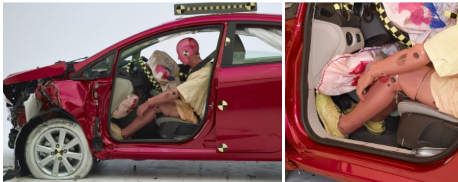
Figur 34. Deformationer i ett test med en 2011 Ford Fiesta.
