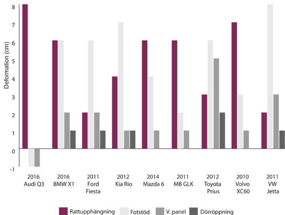
Figur 33. Deformationer i några utvalda punkter för några modeller körda i ODB-prov.
