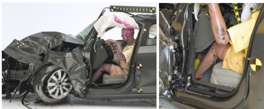
Figur 37. Small-overlap prov med 2012 Audi A4 (MLB plattform)
