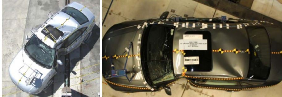
Figur 48. Resultat av stolpkollision med två generationer BMW X3, 2015 (F25 plattform) och 2019 (CLAR).
