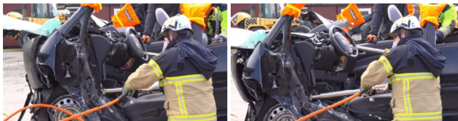
Figur 58. Bildserie av två bilder som illustrerar mittcylindermetoden.
