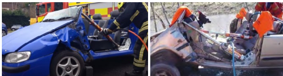
Figur 56. Rotering av frontparti vid rotation av instrumentpanel.
