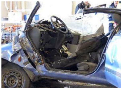
Figur 60. Deformation av karossen med dragmetoden.
