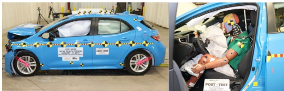
Figur 31. USNCAP prov av Toyota Corolla 2019.
