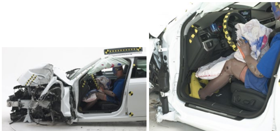
Figur 38. Small-overlap prov med 2017 Audi A4 (MLBevo plattform)
