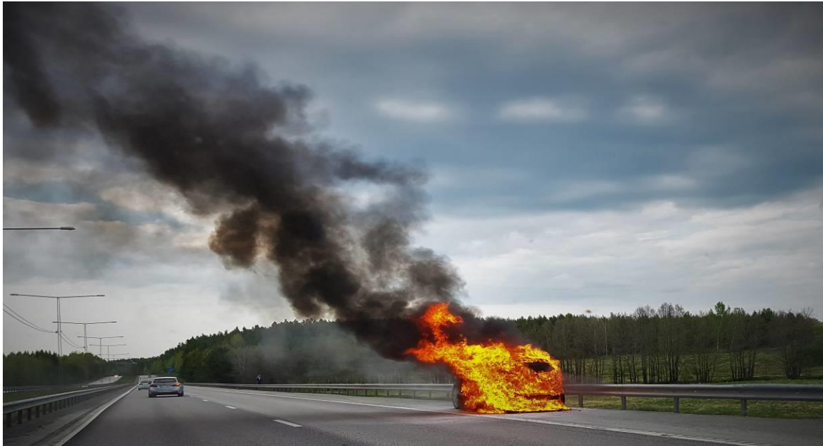
Figur 6. Modernt e-fordon, byggt i komposit, som tagit eld under färd. Lägg märke till rökutvecklingen – hela karossen brinner med lågande brand. Tittar man noga så har framdäcken ännu inte antänts vilket tyder på att branden startat i bakre delarna och med bidrag av vinden rört sig framåt. Röken kan innehålla nanopartiklar från det brinnande kompositmaterialet.
