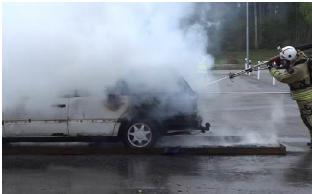
Figur 4. Krister Palmkvist provar skärsläckning av ett e-fordonsbatteri som har startat en s.k. termisk rusning genom yttre påverkan – metoden är ej att rekommendera eftersom penetreringen innebär att termiska rusningen i batteriet ökar och därmed ökar också gasningen (jfr. Försth M et al.2012). Släckinsatsen finns att se på www. https://youtu.be/x1LOuKuwGCg . Filmen visar i första delen hur penetration av batteriet med skärsläckare skadar batteriet så att elden accelererar på grund av tillskottet av elektrisk energi – batteriet kan brinna lång tid – upp till en timme. Andra sekvensen visar prov med skärsläckare på två separata batterimoduler, den vänstra sekvensen visar på cellnivå hur penetration sätter igång en brand och den högra modulen försöker man släcka med skärsläckaren med mycket liten framgång. Skärsläckare är således inte ett rekommendabelt alternativ i dessa fall.
