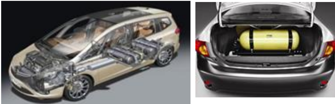
Figur 2. Två exempel på gastankarnas placering.
