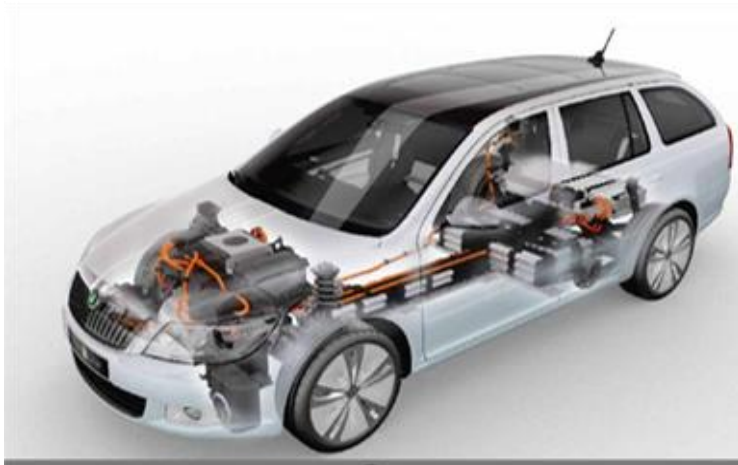
Figur 3. Principiell uppbyggnad av ett e-hybrid fordon med drivbatteri, elmotor- och bensinmotor-drift. Högsäningsskablur har orange färg.
