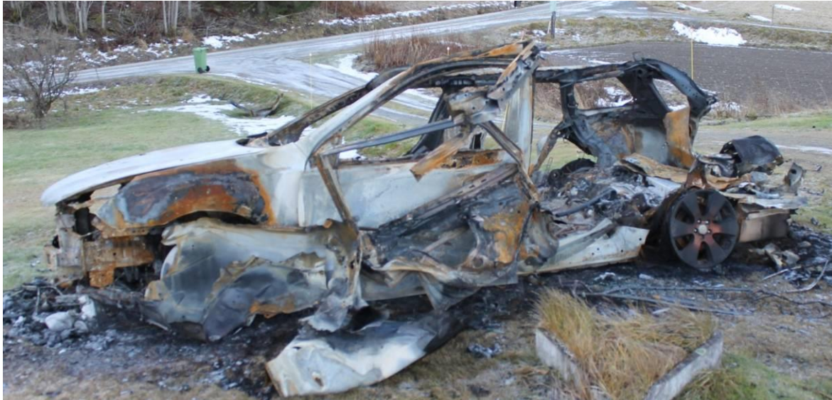
Figur 8. Gasdriven bil som exploderat och brunnit (foto: Räddningstjänsten Höga kusten). Explosionskraften kan illustreras i detta You tubeklipp från Norra Älvsborgs Räddningsförbund: https://www.youtube.com/watch?v=e1h1ItL_pzk
