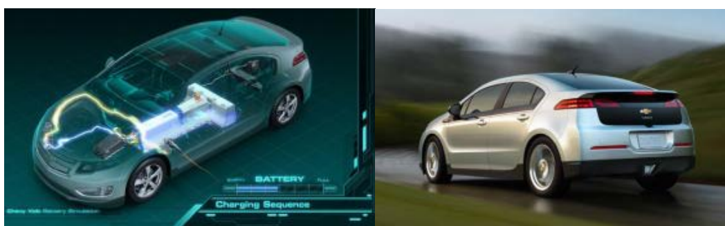
Figur 23 GM Volt har sitt batterisystem monterat golvtunneln och framför bakaxeln (41) (42)
