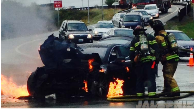
Figur 9 Brand i en Tesla Model S i början av oktober 2013 på avfart från motorväg nära Seattle, Washington. Under färd på motorvägen kolliderade bilen med hårt föremål som trängde in under bilen och orsakade sådan skada på batteripack att brand uppkom. (18) (19)
