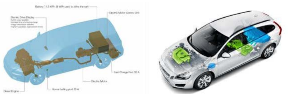
Figur 22 Volvo V60 Plug-in Hybrid med batterisystemet ovanför bakaxeln (39) (40)
