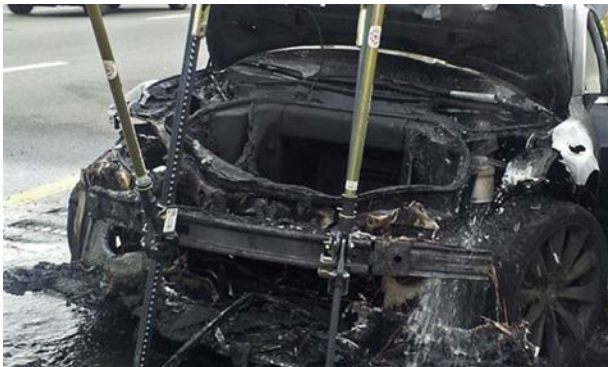
Figur 11 Tredje branden orsakades ännu en gång av att föremål på motorväg trängt in underifrån i e-fordonets främre batteripack och orsakat elfel. (21) (22) (23)
