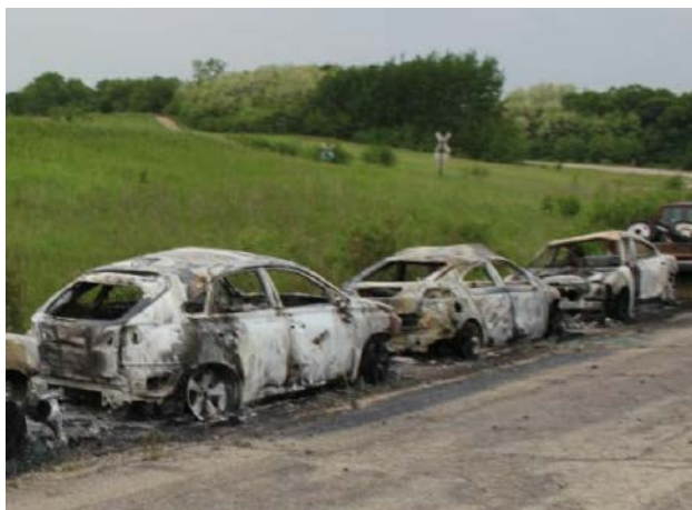
Figur 3 GM-Volt bilen, som visas i mitten av bilden, tog eld tre veckor efter krockprovet (6) (7)
