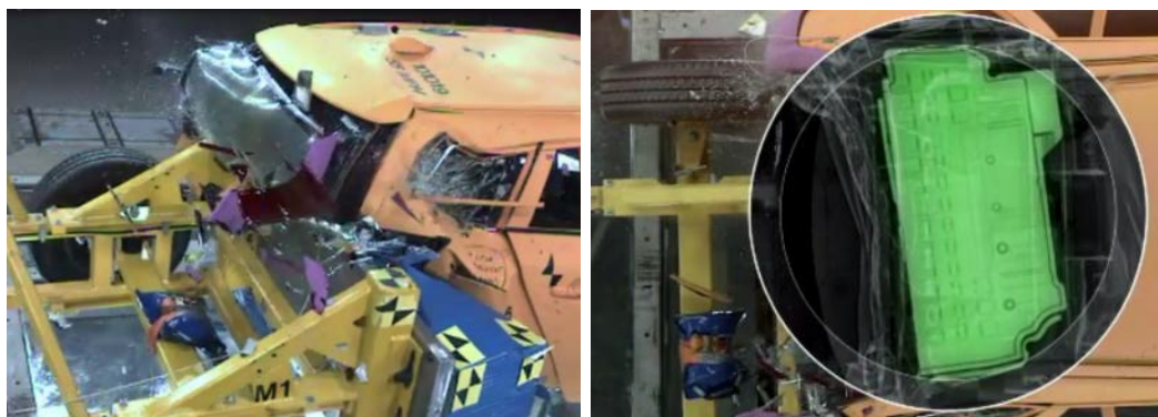
Figur 52 Barriären ska representera en standardmässig personbil som i 80 km/h träffar bilen och tränger in i dess bakre deformationszon. Den högra bilden visar att trots den djupa inträngningen i bilstrukturen så sker inga inträngningar hos detta traktionsbatteri.
