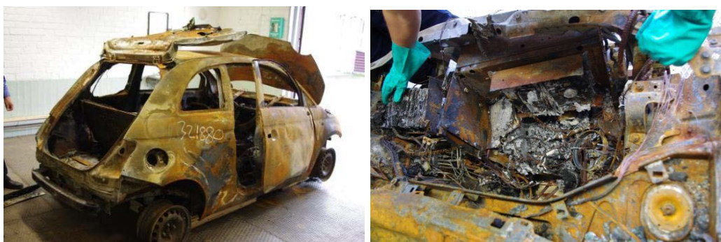
Figur 7 Den utbrunna elbilen sedd snett bakifrån och motorrummet som drabbats värst (17)
