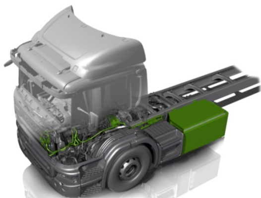
Figur 27 Lastbil med traktionsbatteriet placerat bakom vänster framhjul. (47)
