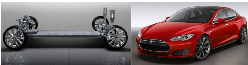
Figur 25 Tesla Model S är en ren elbil med sitt traktionsbatteri under golvet mellan axlarna
