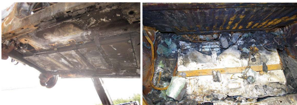
Figur 8 Batteripacket under chassit och batteripacket i bagageutrymmet var inte orsak till branden (17)
