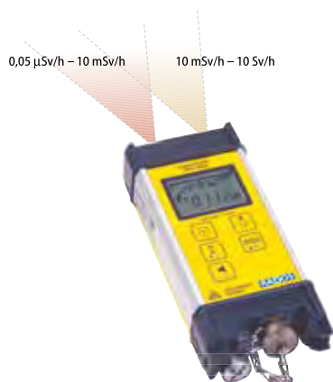
Detektorplacering med mätområden i intensimeter SRV-2000.
