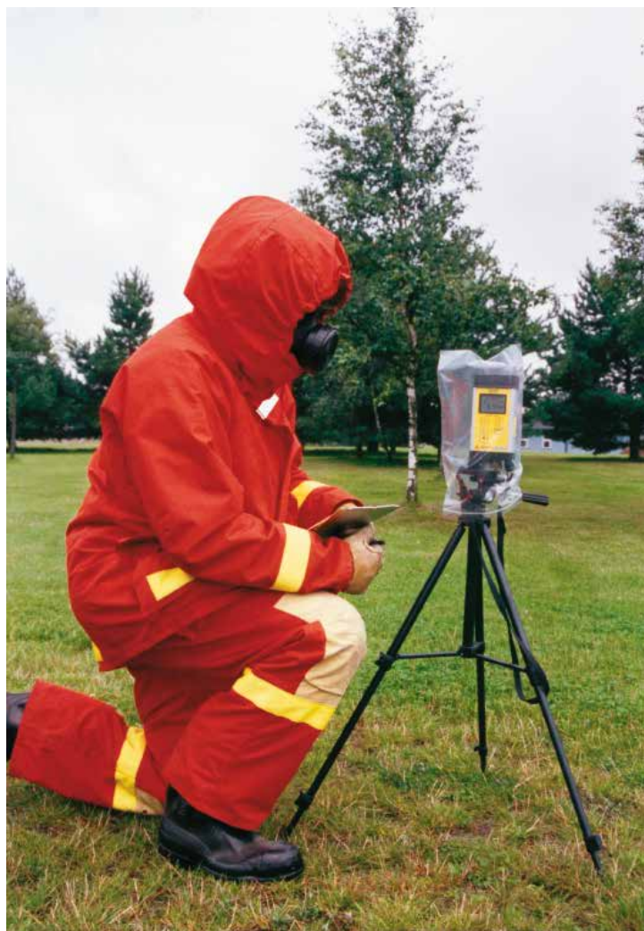
Avläsning av mätning vid referenspunkt vid nedfall.
