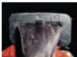
Brännmärken på säkerhetsbältets fästanoordning antyder att föraren hade bältet på sig vid trafikolyckan. Det är enkelt att notera vid räddningsinsatsen.
