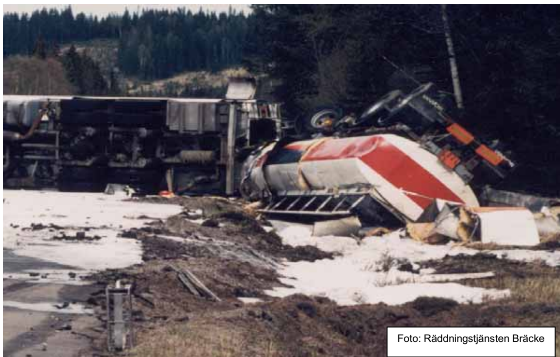
Figur 11. Bild från olycka med bensinbil i Bräcke kommun 1996. Vid olyckan omkom en person i ett kolliderande fordon. Ingen brand uppstod. Cirka 10 m 3 bensin läckte ut till marken från flera läckageställena på bil och släp. Ett lerskikt med gynnsam lutning begränsade spridningen i marken och efterarbetet begränsades till att schakta bort jordmassor för sanering/destruktion.
