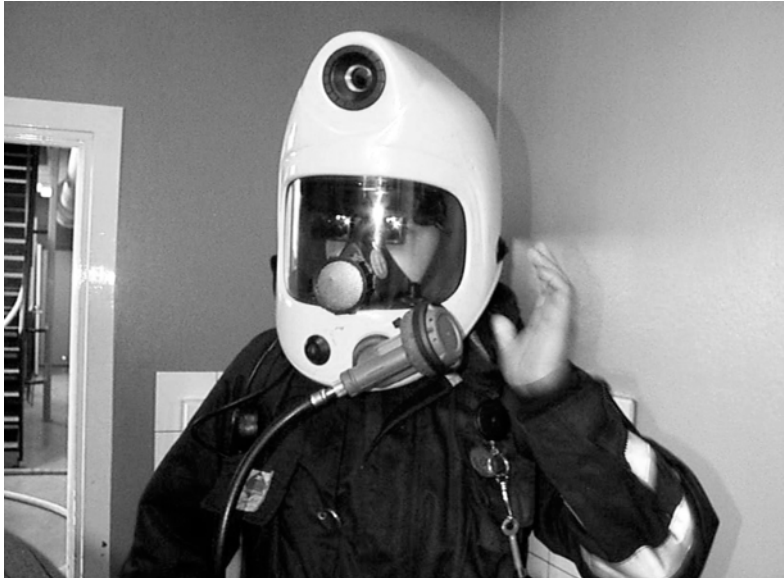
Figur 1. Den modell av IR-kamera som användes vid försöken.
