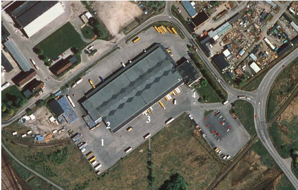
Bild 3. Bedömning av strålningsvärme vid olika tidpunkter på olika avstånd från branden. 1=Lastpallshög som antändes. 2 = Fasad som kunde ej passeras kl 00.00. 3 = Plats för högfordon vid 23.15. 4 = Ledningsplats.
