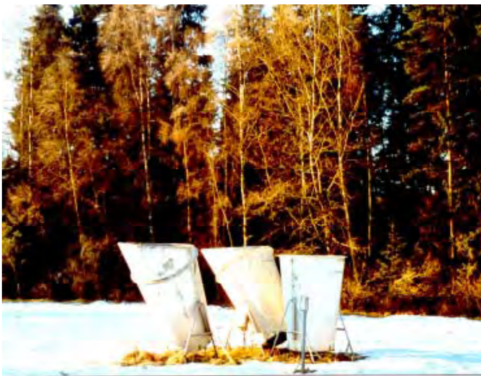
Figur 1. Sodarinstrument för beräkning av vind och vindriktning
