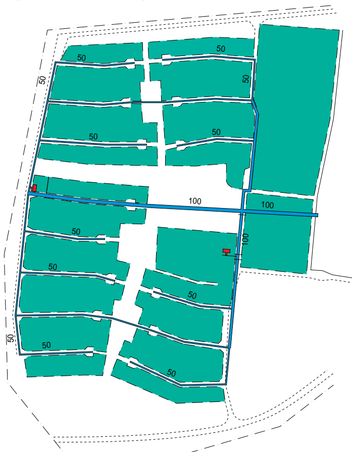
Bild 2.7 Brandposter i ett alternativ system. 50 resp. 100 anger ledningens dimension. (Observera att bilden ej är skalenlig).
