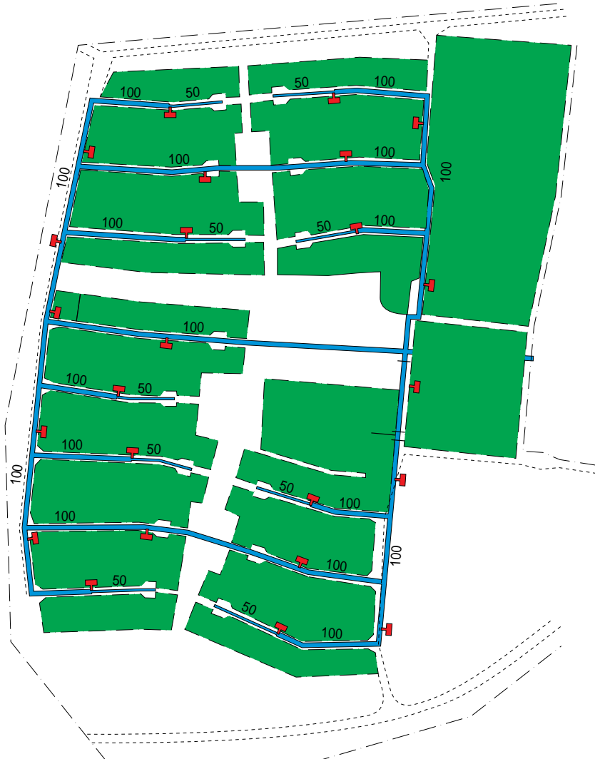
Bild 2.5 Brandposter i ett konventionellt system. 50 resp. 100 anger ledningens dimension. (Observera att bilden ej är skalendig).
