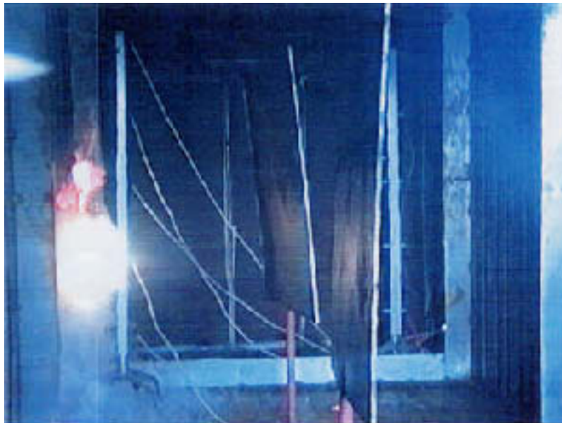
Figur 3. När kondenserad ammoniak träffar en 100 W glödlampa spricker denna så att tändning sker
