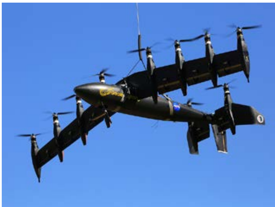
"Greased Lightning". Ett NASA experiment med vertikalstartande UAS med lång uthållighet. Foto: NASA Langley/David C. Bowman – NASA Langley, Public Domain.
