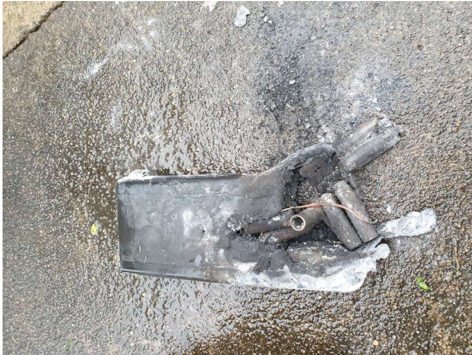
Bilden föreställer ett utbrunnet litiumjonbatteri till elcykel
