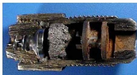
Figur 14. Ej utlöst smältsäkring.
