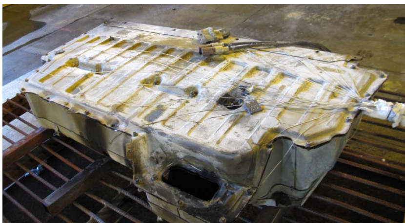
Figur 13: Batteripacket efter brandprovet (fler foton i Bilaga 3).
