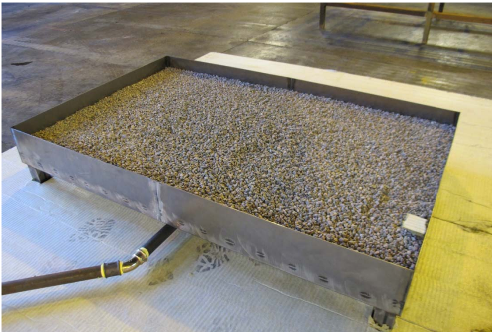
Figur 6: Sandbäddsbrännaren med ytan 140x90 cm. Brännaren matas med gasol som fördelas ut i fyra sektioner.
