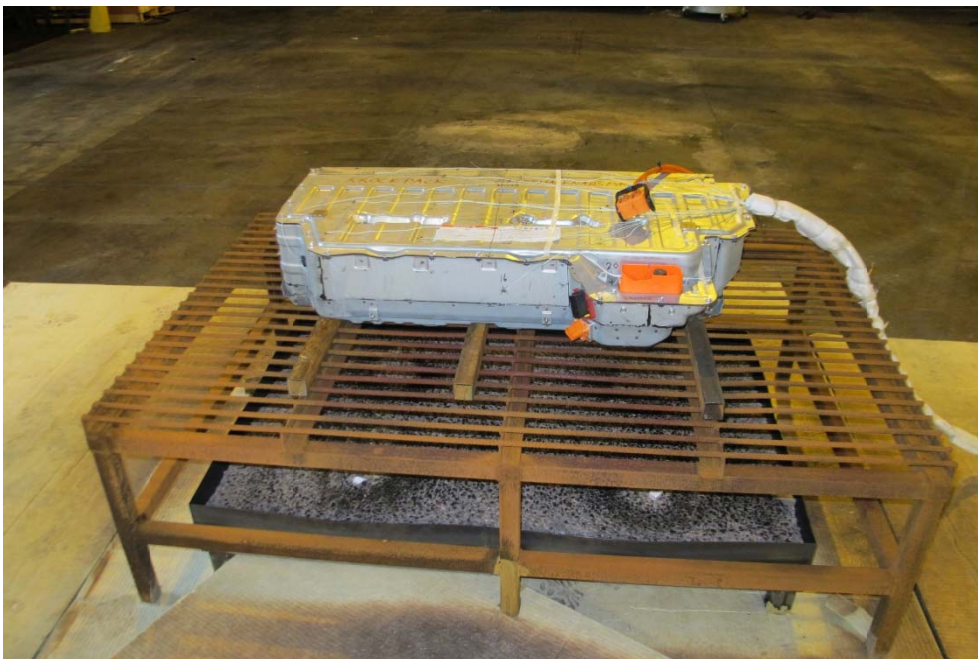
Figur 5: Försöksuppställning med batteripack på ett gallerbord ovanför sandbäddsbrännaren.
