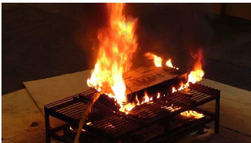
Figur 12: Branden ca 1 minut efter brännaren stängts av.
