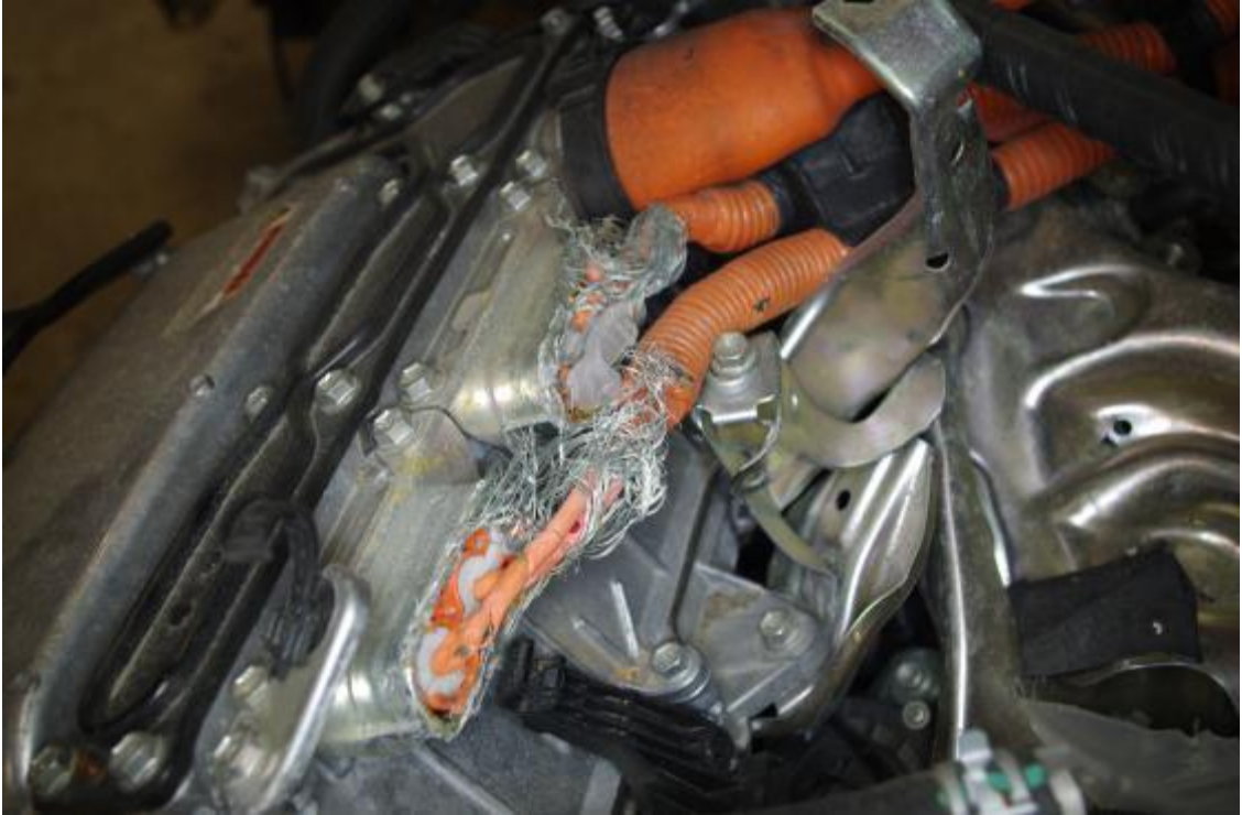
Bild 18 Traktionssystemets kraftelektronik, fotot taget på fordon "C".
