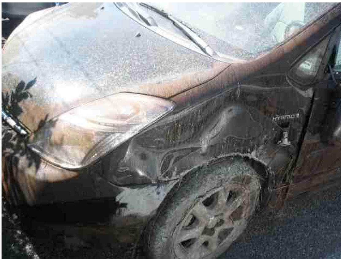
Bild 14 Mekanisk inträngning som ger möjlighet till skada på elcentral under motorhuv.
