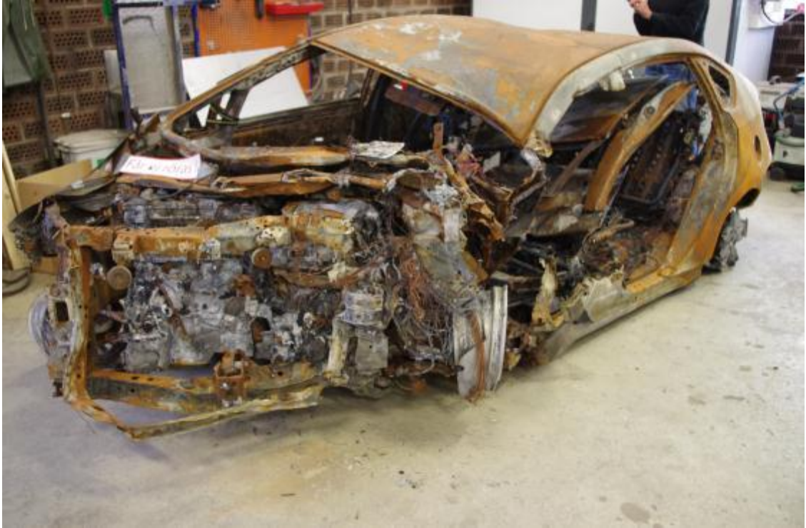
Bild 3 Fordon "B", offsetkrock, fattade eld drygt ett dygn efter trauma.
