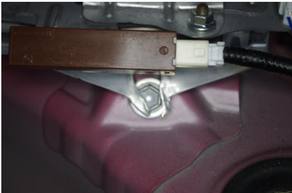
Bild 19 Traktionsbatteriets infästningsöra har dragits av vid krock.
