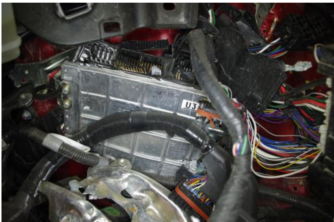
Bild 17 Motorstyr ECU, fotot taget på fordon "C".
