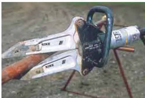
Rörstrypning med spridare.
