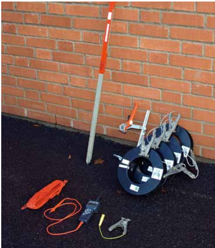
Jordningsutrustning samt mätutrustning för kontroll.
