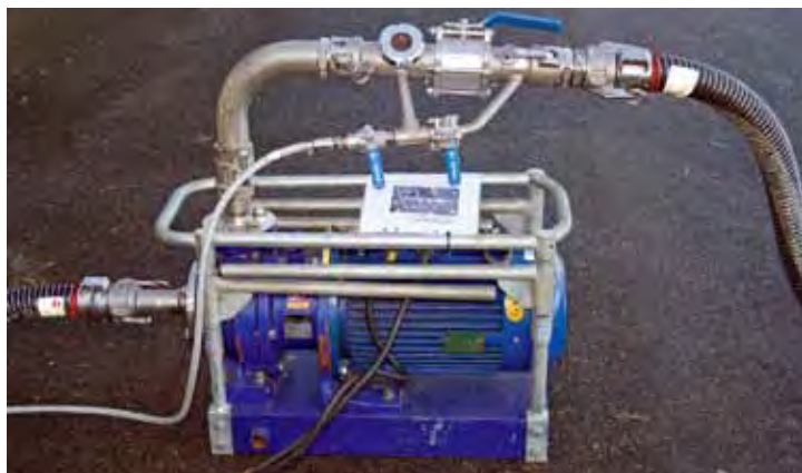
Centrifugalpump med injektor.
