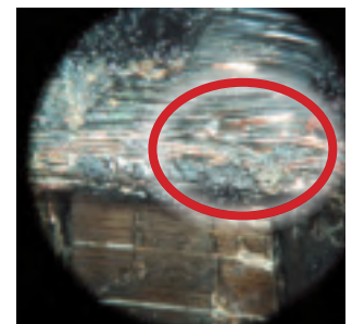
Bild 135. I den röda cirkeln syns en smältskada på drosselns kopparlindning där branden började.
