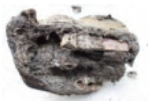
Bild 78. Ett startrelä som har börjat brinna och det syns att det blivit en kolbildning. Bränder i startreläer beror på att gnistor bildas i dem. På bilden ser man att värmen kom inifrån startreläet.
