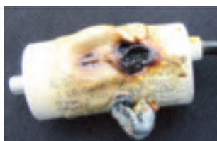
Bild 91. En kondensator som det varit ett brandtillbud i.
