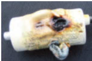
Bild 82. En kondensator som det varit ett brandtillbud i.
