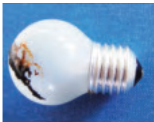
Bild 85. En klotlampa på 40 W har orsakat en brand på ett äldreboende genom att brännbart material placerats mot lampan.
