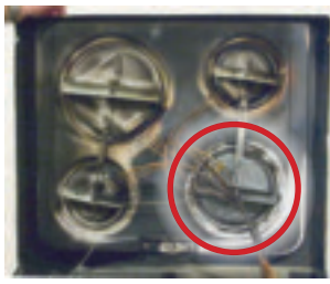
Bild 138. Plattan nere i högra hörnet är den platta som varit påslagen. Bilden är tagen på undersidan av spishällen
