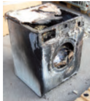
Bild 163. Tvättmaskinen som brunnit.
