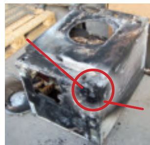
Bild 165. Ett brand-V som skulle kunna visa primärbrandområdet. Cirkeln visar ett område där det varit höga temperaturer. Även botten är skadad, vilket framgår av bilden.
