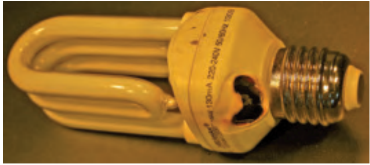
Bild 7. En lågenergilampa som det brunnit i.
