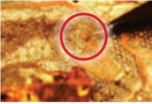
Bild 100. Platsen på kretskortet där branden börjat framgår av den röda ringen. Koppar har smält bort på platsen inom den röda ringen. Pennan visar en liten bubbla av koppar – ett spår efter höga temperaturer.
