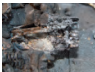
Bild 168. Stift dit elkablar varit anslutna. Stiftet är värmeskadade i hela sin längd och de var hårt satta i ändarna, vilket tydde på att de varit utsatta för branden i ett tidigt skede. Det fanns också en del svart poröst material runt stiftet. Kablarna hade tagits bort innan bilden togs.
