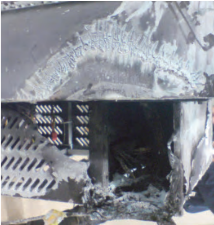
Bild 132. Bilden på fryssboxen visar ett tydligt brand-v.
