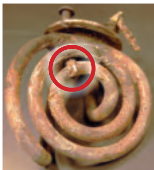
Bild 156. En smältskada på värmslingan i vattenkokaren syns i den röda cirkeln. För att en sådan smältskada ska uppstå krävs mycket höga temperaturer. Branden har börjat där skadan finns. Anledningen till skadan kan exempelvis vara ett fel på termostaten eller fukt i slingan. En kortslutningskada hittades på anslutningskabeln till vattenkokaren.
