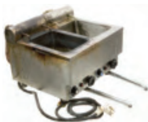
Bild 127. En fritös som det börjat brinna i.
