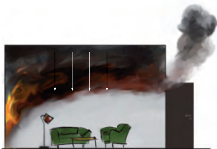
Figur 26. En brand där varma brandgaser samlas i taket och börjar ge strålning mot saker i rummet.
