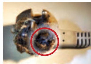
Bild 113. Stickproppen till spisen. I ringen finns resterna av det ena stiftet. Stickproppen har haft fyra stift (tre faser och en jord).
