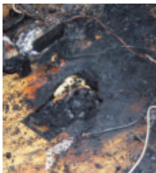
Bild 95. Hålet i golvet där sollampan "kolat" igenom.
