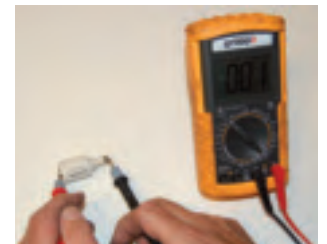
Bild 15. Mätning om en proppsäkring är hel. På detta sätt mäts resistansen i säkringen.
