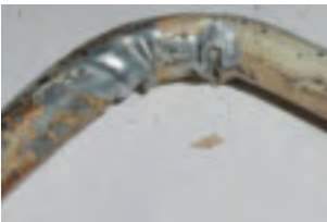
Bild 121. En kuloledning som böjts för mycket så att böjningsradien blivit för liten och kabeln har tagit skada.
