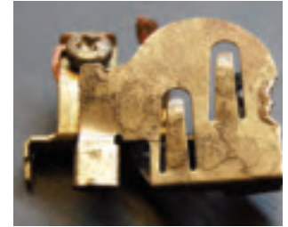
Bild 133. Kopparbleck som finns i startreläer. På bilden syns att kopparblecket fått skador av de höga temperaturerna från ljusbågar.
