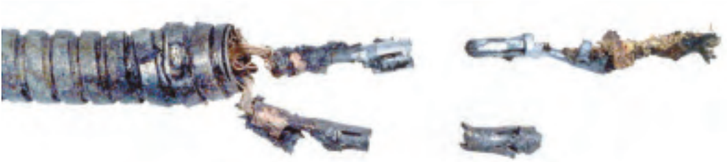
Bild 41. Anslutningen där branden börjat. Det syns tydligt att det undre stiftet och hylsan är mer brandskadade och att branden har börjat där.
