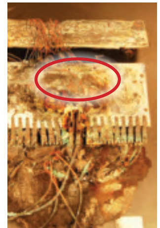
Bild 99. Ett kretskort i en diskmaskin som det börjat brinna på. Branden har börjat i den röda ringen.
