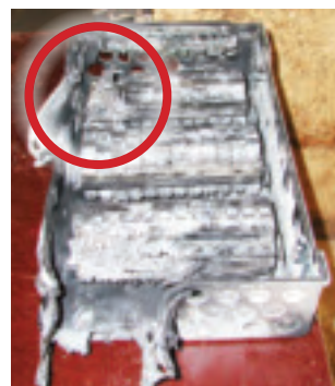
Bild 108. En elcentral där branden börjat i huvudbrytaren. Huvudbrytarens placering framgår av den röda ringen.
