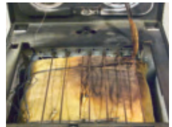
Bild 139. På bilden syns tydligt vilken platta det är som varit varmest.
