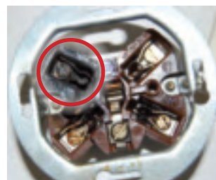
Bild 114. Ringen visar var glappkontakten uppstått i vägguttaget.
