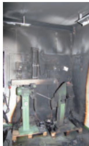
Bild 175. Bilden visar primärbrandområdet, de två slipmaskinerna, var kortslutningsskadorna hittades samt var uppsamlingspåsen satt före branden.
