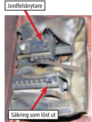
Bild 154. Bilden visar att jordfelsbrytaren och en säkring var i frånslaget läge efter branden. Det syns även att huvudbrytaren har slagits ifrån efter branden.
