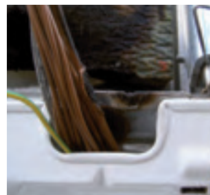
Bild 51. Brandtillbud i en lucka i en diskmaskin. Kablarna gick till luckan på diskmaskinen och skavde mot metallkanten när luckan öppnades och stängdes.
