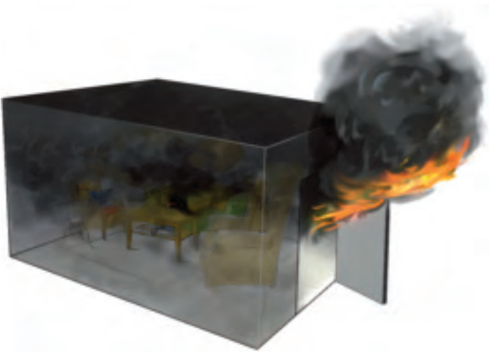
Figur 35. Brandförloppet återupptas när luft (syre) sugns in. Med syret bildas en brännbar blandning som kan antändas av en tändkälla.
