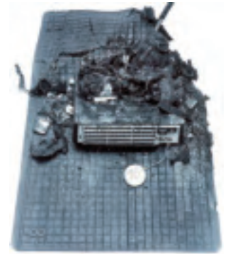
Bild 42. Kupévärmaren som det brunnit i.
