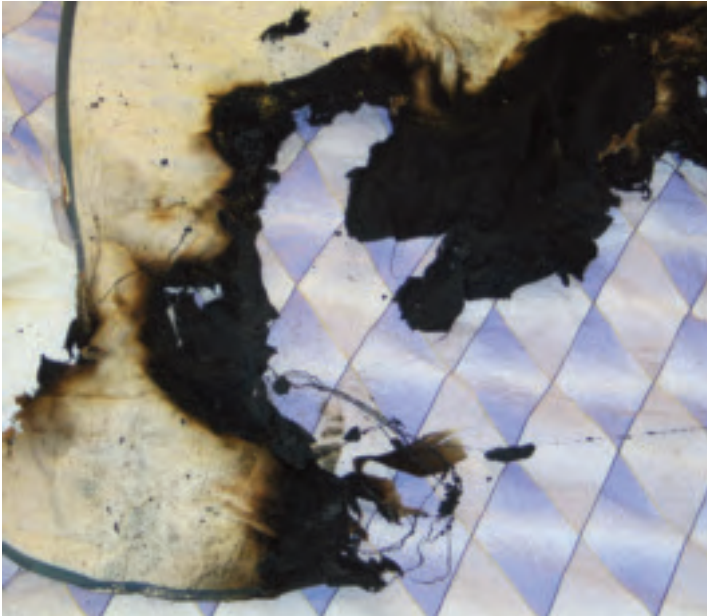
Bild 157. Bäddvärmaren som brunnit.
