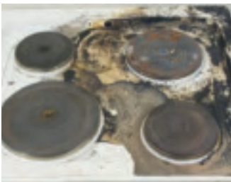
Bild 137. Det har brunnit vid plattan längst upp till höger.
