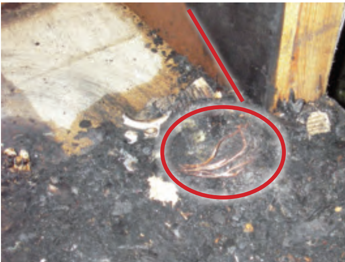
Bild 126. På bilden syns ett brand-V (rött streck) samt resterna av sladdvinnan (röd cirkel).
