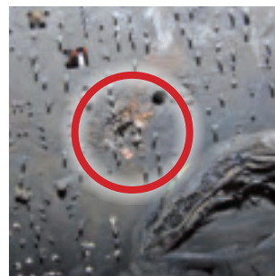
Bild 151. Bilden visar baksidan av kretskortet. I markeringen syns var branden börjat.
