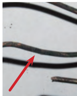
Bild 122. De tre ledarna som fanns i kabeln. Den röda pilen visar var smältskadan på fasledaren hittades.
