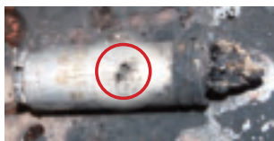
Bild 90. En kondensator som har orsakat en brand i ett lysrör. Att kondensatorn orsakat branden framgår av de hål som finns i den röda ringen.
