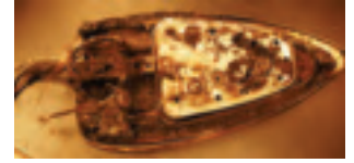
Bild 142. Värmeslingan i strykjärnet finns under den blanka plåten.
