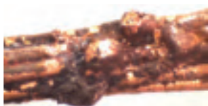
Bild 169. Kortslutningsskadan som hittades. Det syns en tydlig bubbla i mitten med en krater runt. Bilden är tagen i ett mikroskåp.
