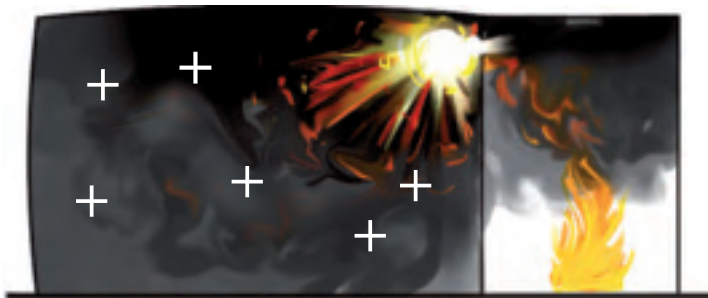
Figur 43. Antändning av brandgaser i ett angränsande rum till brandrummet.
