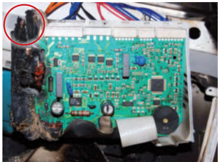
Bild 102. Kretskortet som det brunnit. En röd cirkel visar kontakten där branden startat.
