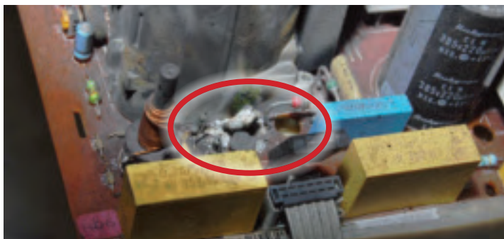
Bild 148. Ett kretskort i en tv där en komponent blivit överhettad, vilket hade kunnat leda till en omfattande brand.
