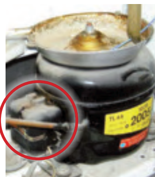
Bild 80. Startreläets placering på en kompressor. Kompressorn sitter normalt nere vid golvet på baksidan av en kyl eller frys. Startreläet är markerat med cirkeln.
