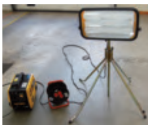
Bild 160. Exempel på hur belysningen kan ordnas på en brandplats. Elaggregat, en skarvsladd samt en lampa. Elaggregatet ska stå utanför byggnaden och sladdvindan ska vara utrullad. Lampan har i detta fall en effekt av 3 x 36 watt.
