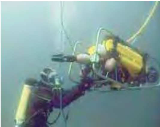
Dykare från kustbevakningen som arbetar med DOLS, Diving Oil Lightering System. Utrustningen används för att tömma sjunkna fartyg på olja.
