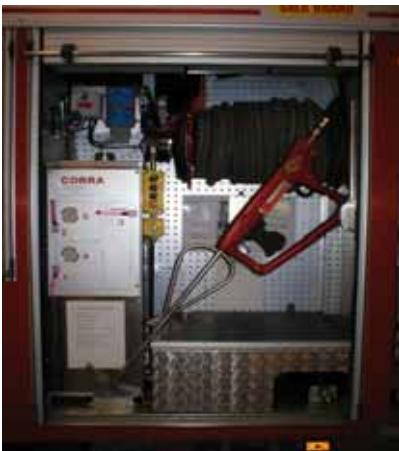
Skärsläckare placerad vänster bak i basbil SDD 24101, Räddningstjänsten Eskilstuna
