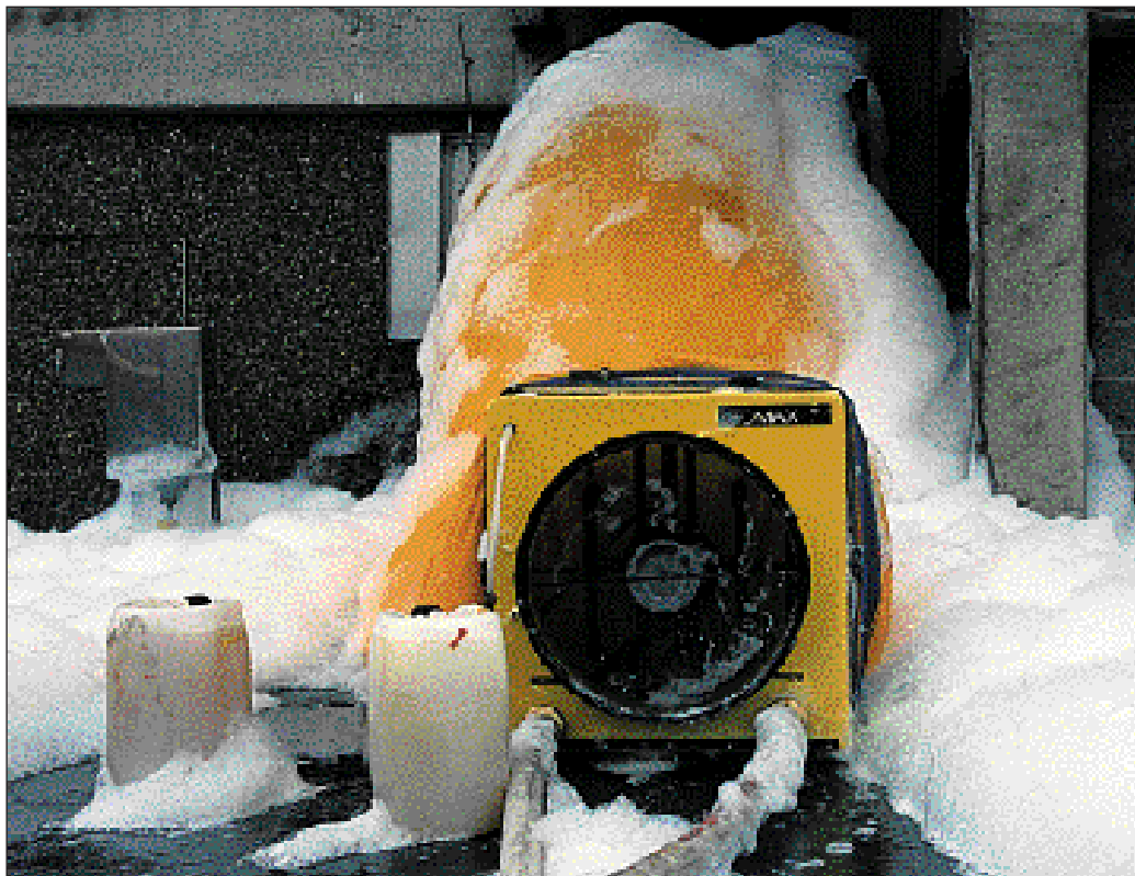
Ett tecken på att det är för stort mottryck i rummet är att premix rinner ut bakvägen genom lättskumsaggregatet
