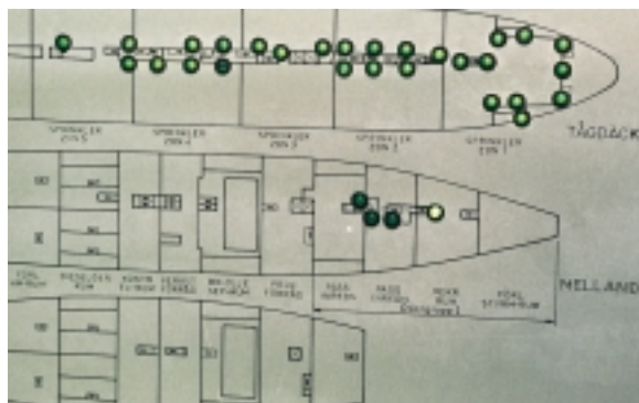
Schema över vattentäta sektioner/dörrar
