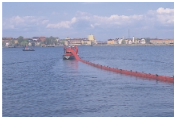
Utläggning av läns
