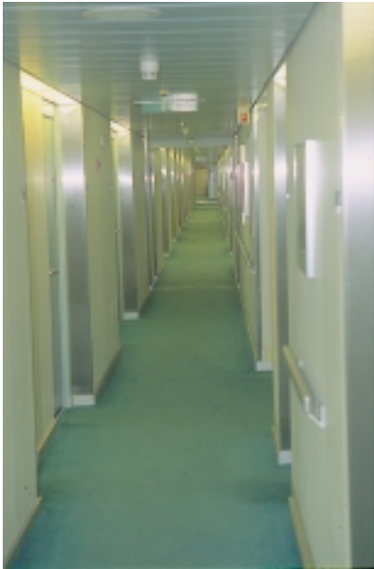
På svenska fartyg ska i korridorer finnas en branddörr på minst var fjortonde meter
