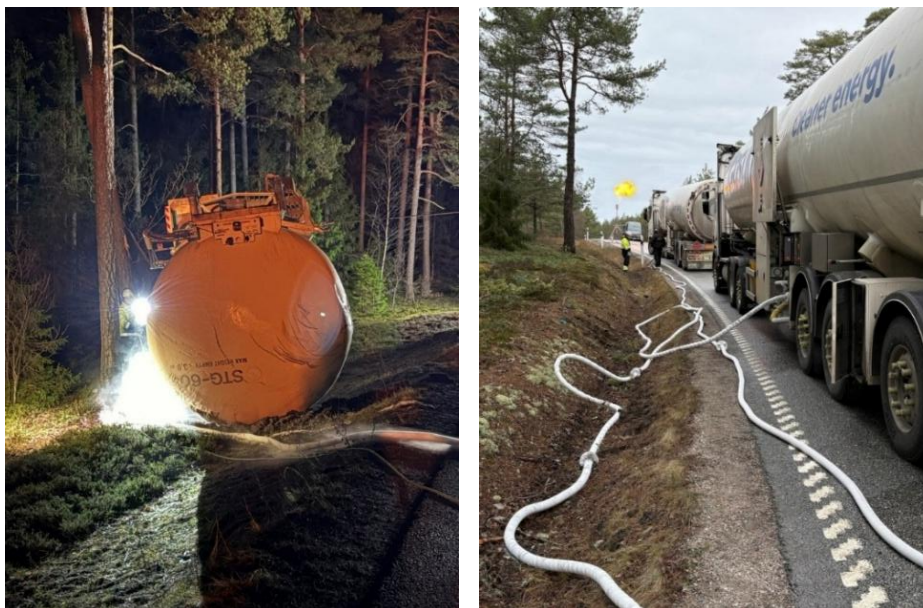
Figur 10: Vänster: Läktring och fackling pågår medan trailern ligger i diket. Höger: Fackling innan transporten till Nynäshamn. (Foto: Gasum)
