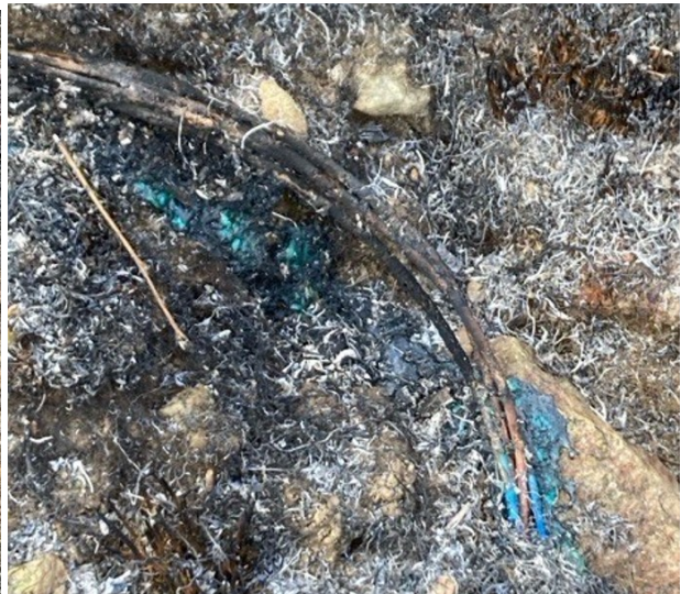
Figur 5. Kablage på marken från solcellsanläggningen (förstorat till vänster). Källa: Räddningstjänsten Gislaved-Gnosjö.
