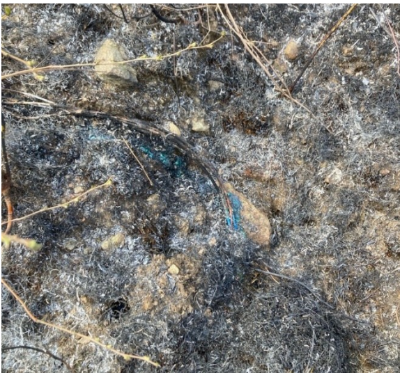
Figur 5. Kablage på marken från solcellsanläggningen (förstorat till vänster). Källa: Räddningstjänsten Gislaved-Gnosjö.
